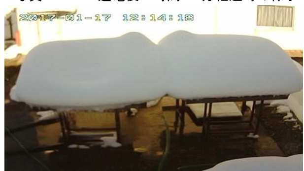
写真 3. 12 A 通電後 4 時間 11 分経過時の様子
