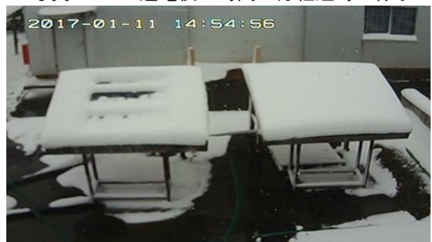
写真 2. 9 A 通電後 6 時間 32 分経過時の様子
