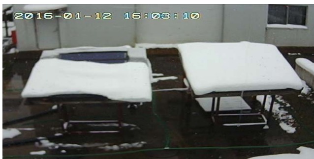
写真 2 5A 通電加熱終了時の様子
