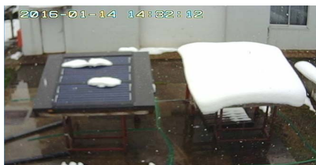
写真 3 7A 通電加熱終了時の様子
