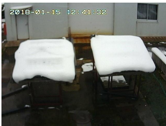
写真3. 10A 通電後 2 時間 04 分経過の様子
