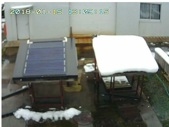
写真4. 10A 通電後 2 時間 32 分経過の様子
