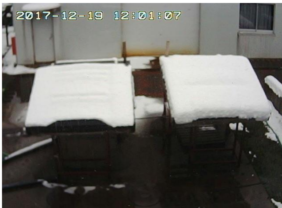
写真1. 8A 通電後 1 時間 06 分経過の様子
