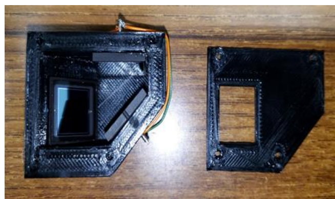
図 2 光トラップ検出器のフォトダイオードを固定するケース兼フォルダ (左) とそのふた (右)
