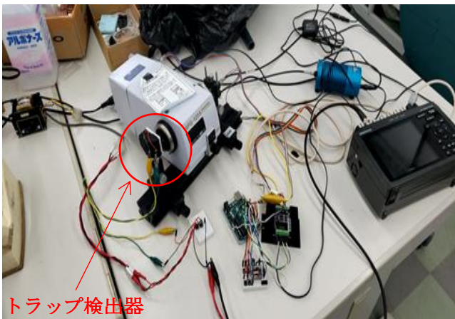
図3 製作したトラップ検出器を用いて、光電流スペクトルの測定
