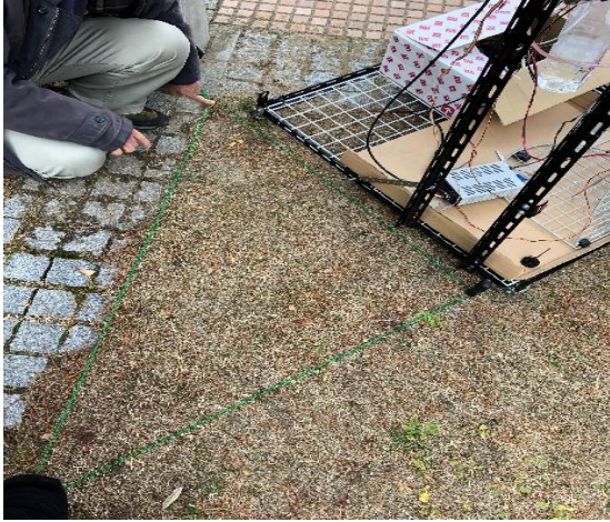
図 2 ひもで三角形を形成して正しい角度設定で追尾装置を真北方向に設置
